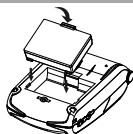
Instalação da Bateria
