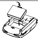
Instalación de la batería
